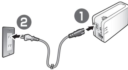
● 壁のコンセントに直接接続します。
